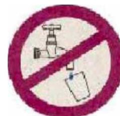
13. Das Brauchwassernetz darf innerhalb des Gebäudes keine Zapfstellen aufweisen. Außenliegende Zapfstellen für Beregnungswasser sind zusätzlich durch Steckschlüssel vor unbefugter Benutzung zu sichern.
