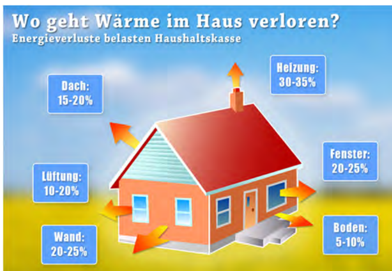
Abbildung 4-2: Energieverluste bei der Wärmeversorgung bestehender Wohngebäude 49
