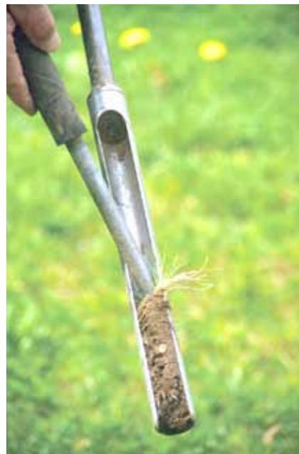
Bodenprobe mit Bohrstock
